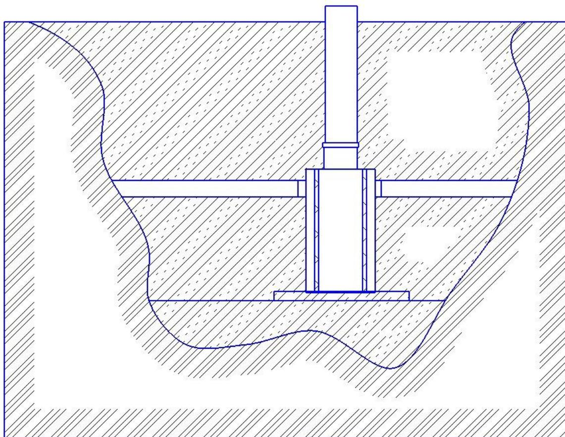
Если погреб устанавливается на территории стоянки или под проезжей частью, необходимо предусмотреть изготовление ж/б плиты и окончательную засыпку следует производить песком без использования местных грунтов, а также предусмотреть установку чугунного канализационного люка типа Т.
