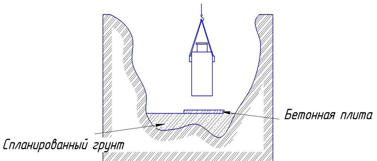
Корпус погреба крепится к бетонному основанию в котловане с помощью анкерных болтов и синтетических тросов. Расстояние от стенок котлована до стенок корпуса колодца не должно быть менее 200 мм.
