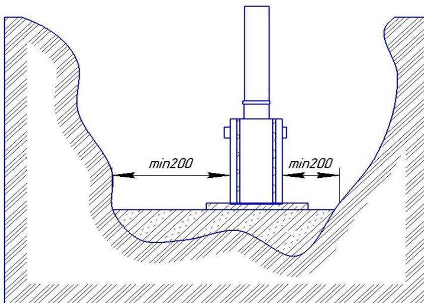
Перед обратной засыпкой убедитесь, что корпус погреба не имеет повреждений. Обратная засыпка на высоту корпуса погреба производится смесью песка и цемента в соотношении 5:1. Окончательная засыпка может быть выполнена местным грунтом. При несоблюдении этих условий, возможна деформация корпуса или горловины.
